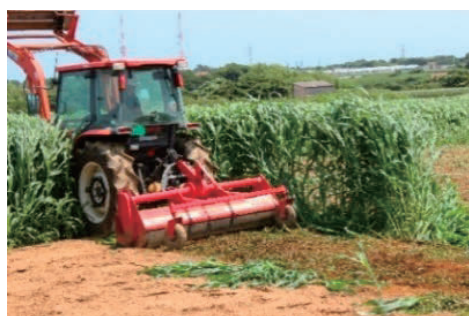
フレールモアによる細断
